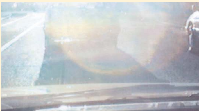
Lågt stående vår- och höstsol är mycket besvärande. En sliten ruta förvärrar problemet.
